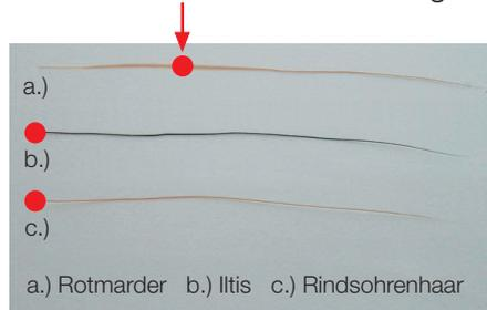
Bei Pinselkörpern, die zu kurz in der Fassung stecken, liegt die Basis der Elastizität daher außerhalb der Zwinge.
